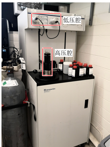
图3 AutoPore IV 9500 型压汞仪 Fig.3 AutoPore IV 9500 MIP apparatus
