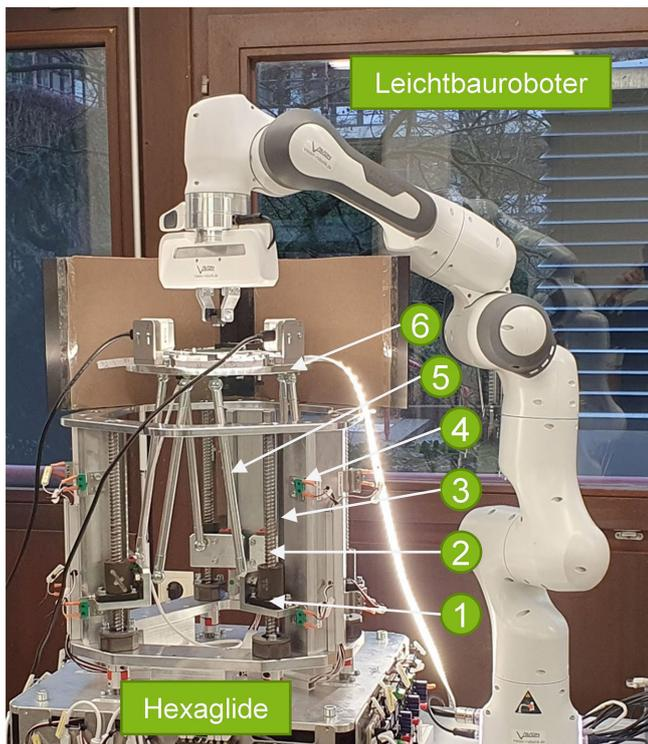
**Bild 1.** Montagesystem bestehend aus dem Hexaglide und einem Leichtbauroboter: 1 – Spindelwinkel, 2 – Gewindespindel, 3 – Gleitschiene, 4 – Endschalter, 5 – Stange mit Kugelgelenken, 6 – Plattform.
