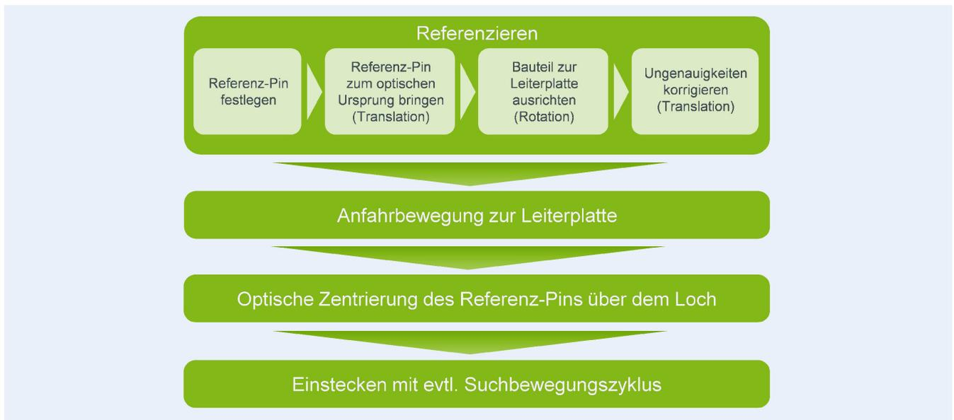
Bild 3. Steuerungsablauf der intelligenten THT-Bestückung. Grafik: IPS
